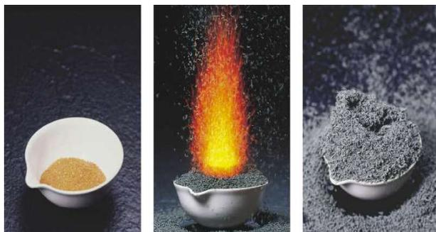
La Figura 18 muestra tres imágenes de la reacción de formación de óxido crómico ( $\text{Cr}_2\text{O}_3$ ).
